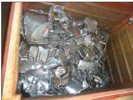
Bild 3: Fraktion Aluminium mit Anhaftungen
