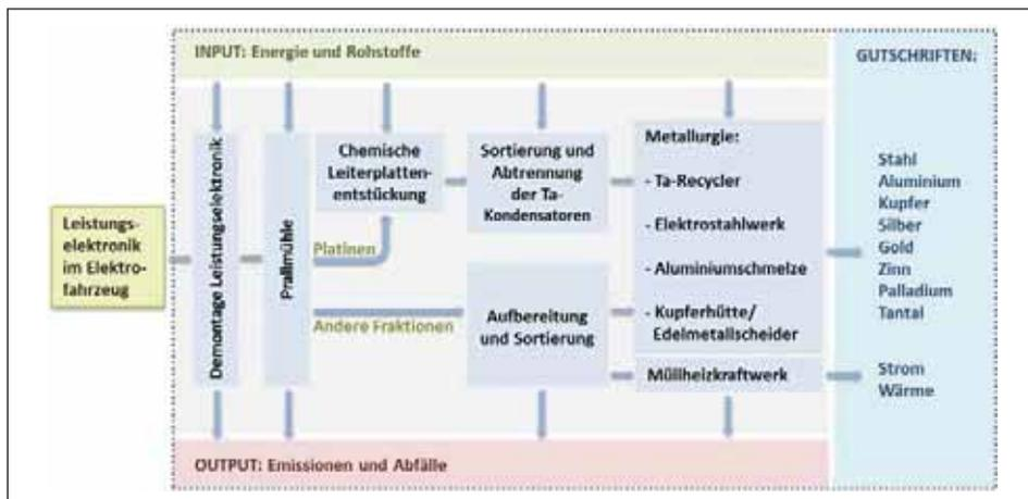
Bild 7: Systemgrenzen der Elektrorecyclingroute mit chemischer Platinenentstückung
